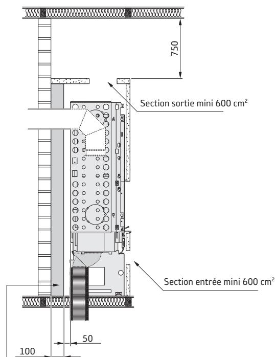
Peut être omis si la cheminée en maçonnerie arrière est approuvée et assure une protection suffisante selon le technicien agréé pour l'inspection.
