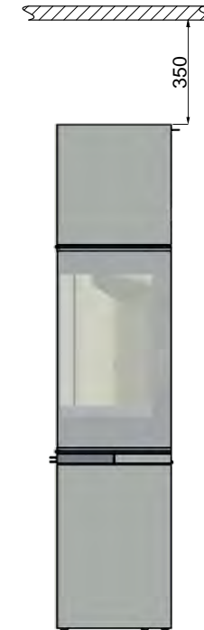
Plafond et sol en matériau combustible
