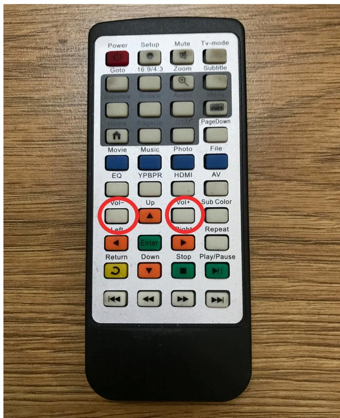
Om het volume aan te passen, plaatst u de afstandsbediening zoals weergegeven in de onderstaande foto en drukt u op de knop "**Vol +**" om het geluid te versterken, druk op de knop "**Vol -**" om het geluid te verlagen.
