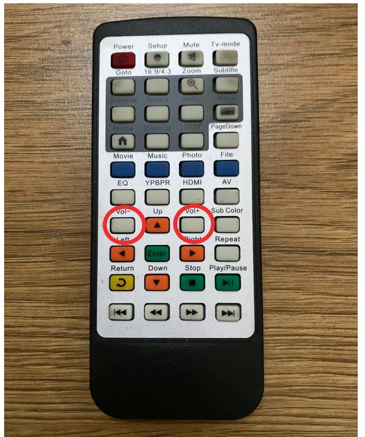
Zur Lautstärkenregelung, Fernsteuerung wie auf nachstehendem Foto angegeben, positionieren und die Taste „Vol +“ drücken, um die Lautstärke zu erhöhen und die Taste „Vol –“ drücken, um die Lautstärke zu verringern.
