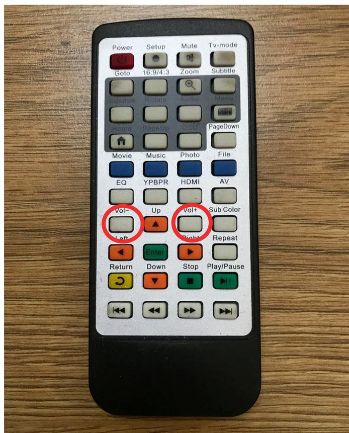
Per regolare il volume, posizionare il telecomando come indicato nella foto in alto e premere il tasto "Vol + " per aumentare l'audio, premere il tasto "Vol - " per diminuire l'audio.
