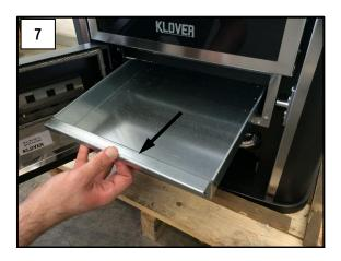
Il est recommandé de vider le tiroir à cendres (figure 7) pour garantir une bonne entrée d'air comburant. Il convient également d'enlever au fur et à mesure l'éventuel résidu de cendres dans la chambre de combustion.
