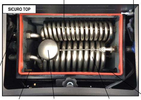
Vanne automatique purge air (jolli) Puits porte-sonde de température de l'eau. Flotteur pour le chargement de l'eau dans le corps de la chaudière. 5 Échangeur de chaleur primaire (chauffage).
