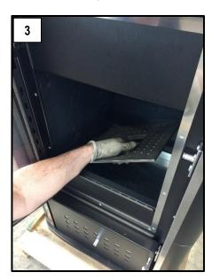
Supprimer les cinq cloisons en fonte à l'intérieur de la chambre de combustion (figure 1). Puis retirer le brasier en fonte (figures 2 et 3). Procéder à l'élimination de tous les dépôts des parois de la chambre de combustion.
