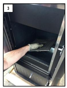
Supprimer les cinq cloisons en fonte à l'intérieur de la chambre de combustion (figure 1). Puis retirer le brasier en fonte (figures 2 et 3).
