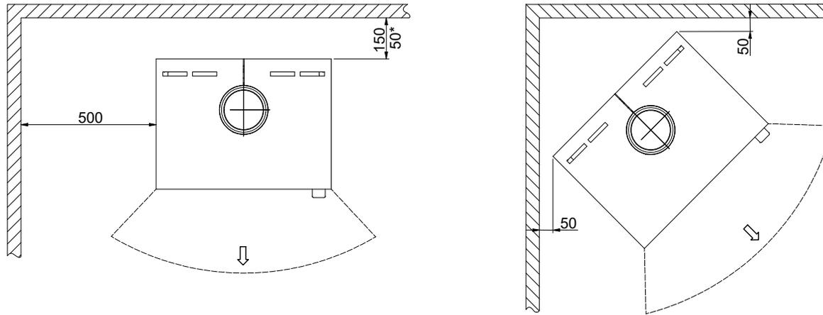
Distance minimale à un mur inflammable avec une protection thermique
