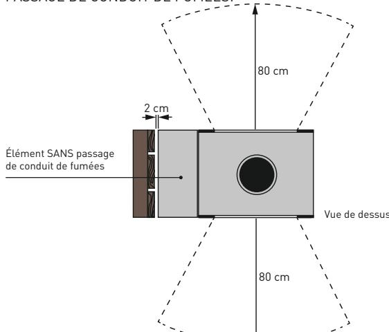
Le côté extérieur latéral des éléments dans lesquels aucun conduit de fumées n'est intégré peut être installé à 2 cm des éléments de construction ou parois combustibles du fait de l'absence d'échauffement pendant le fonctionnement.
