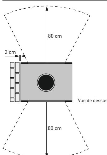
Par rapport aux cloisons/matériaux incombustibles (par ex. béton, pierre, crépi), l'espace de sécurité sur le côté/en arrière peut être réduit à 2 cm.
