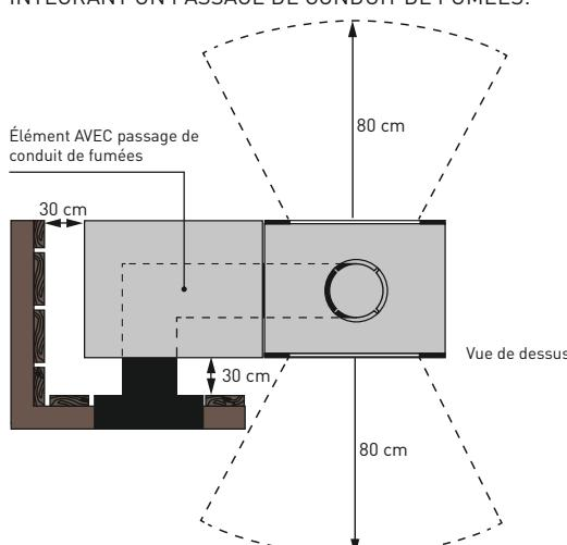
Les éléments dans lesquels passent les conduits de fumées doivent être installés à au moins 30 cm des éléments de construction ou des parois combustibles (veuillez respecter la norme DIN du conduit de fumées/de la traversée à paroi).
