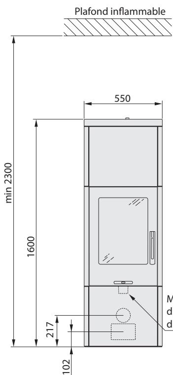
Installer le poêle sur une plaque de sol et vérifier que les distances d'installation mentionnées sur les schémas sont respectées. Prévoir une distance minimale de 1 mètre entre l'ouverture du poêle et les éléments inflammables du bâtiment ou du décor.
